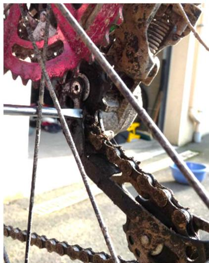
Appliquer, le dégraissant sur la cassette, les galets du derailleur, la chaîne, les plateaux des deux cotés.
