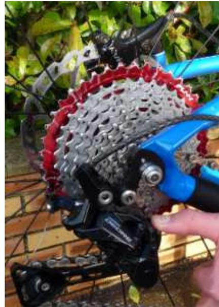
Avant de démonter la roue arrière, toujours mettre la chaîne sur le petit pignon de la cassette. Le remontage de la roue sera plus facile, il suffira de mettre la chaîne sur le petit pignon. Pour les dérailleurs qui en sont équipés, déverrouiller le système anti-saut de chaîne.
